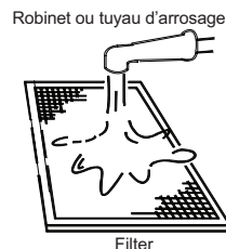
Figure 6. Retrait et nettoyage d'un filtre typique
